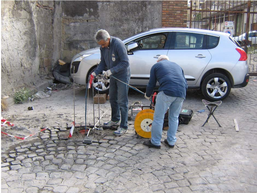
Esecuzione prova geofisica in foro "Down Hole"
